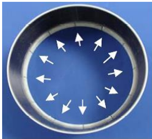
Fig.8. Eprouvette technologique (flèches : application locale des déplacements radiaux).
