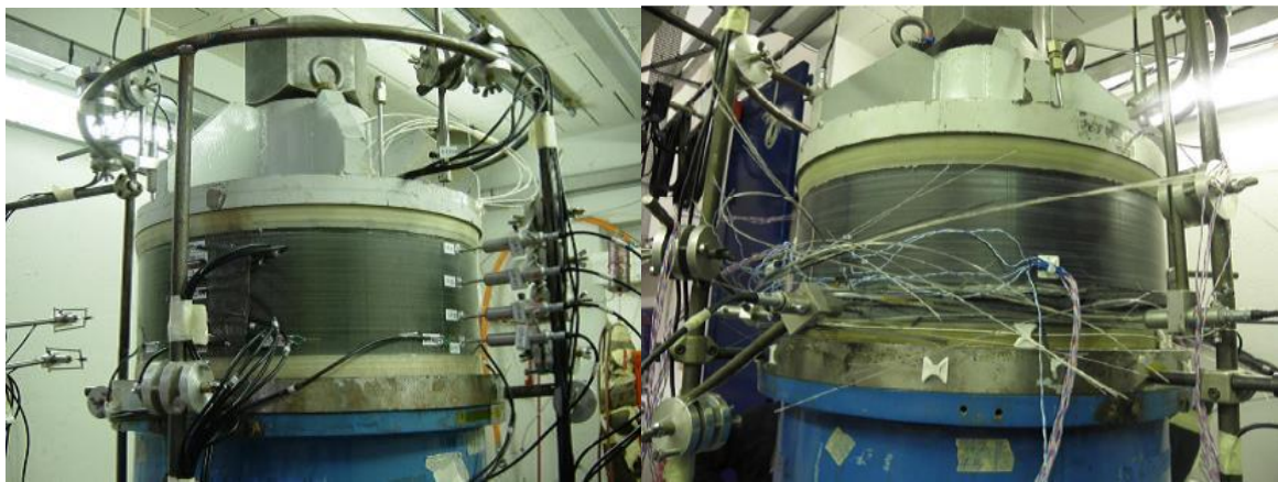
Fig.10. Jupette intégrée sur le bâti d'essai. Rupture en compression + déplacement radial.
