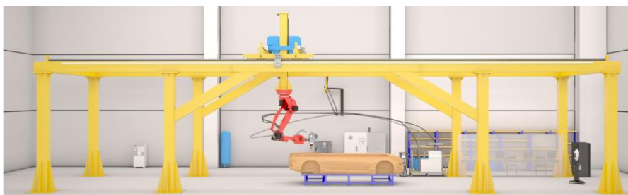
Figure 1: Principe de fonctionnement de la cellule robotisée de fabrication additive et soustractive du projet H2020 Kraken[1]
