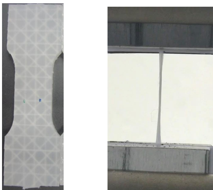
Fig. 1. (a) Photo d'une éprouvette de SRPE contenant 3 fils orientés dans la direction de sollicitation (b) Essai de traction sur fil seul
