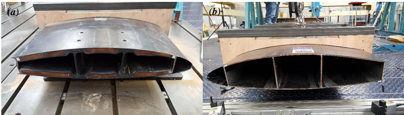
Fig. 1. Vue transversale d'une aile caisson (a) coté emplanture - (b) coté « winglet »
