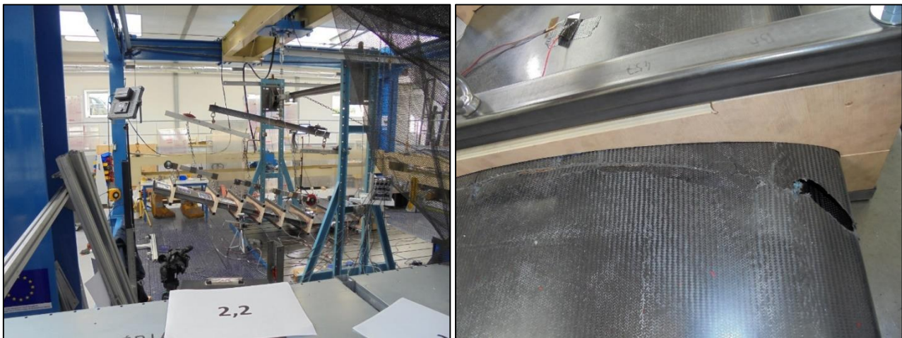
Fig. 10. Rupture de l'aile à 13.2G
