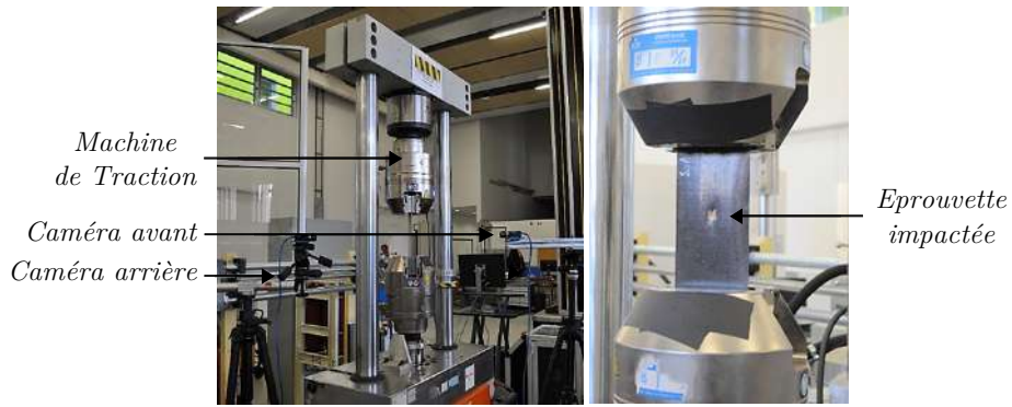
Fig. 2.: Conditions expérimentales de l'essai de traction sur éprouvette impactée
