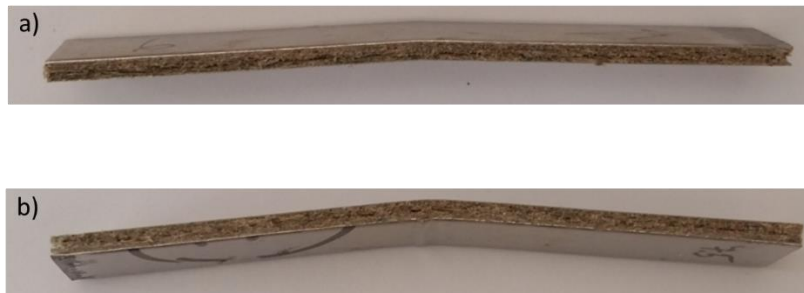
Fig. 4. Faciès de rupture des éprouvettes de flexion: a) sans film, b) avec film.
