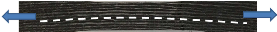
Fig. 4 : Zone utile d'une éprouvette haltère avec courbure des strates de renfort.
