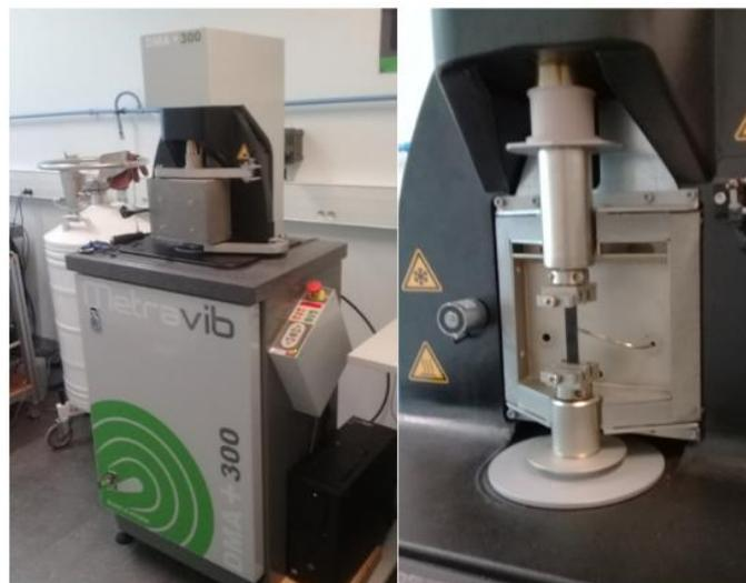
Fig. 4. Machine DMA Metravib et montage de l'éprouvette
