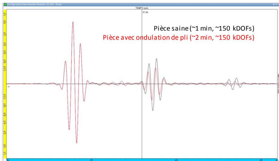
Fig. 8. Signaux AScan de la pièce saine (en noir) et avec ondulation de pli (en rouge).
