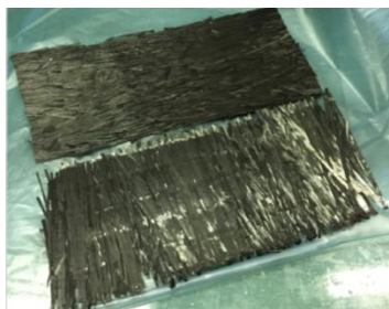
Fig. 7.a bandes de FCrR assemblées pour réaliser un pseudo NCF 0°-90°
