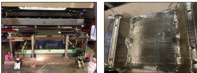
Fig. 13 : Moule de préformage, et préformes sèches 3D.
