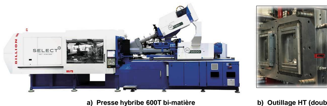
Fig. 14 : Unité de production C-RTM TP : Presse Billion hybride 600T bi-matière / moule HT Pernoud à double cavité (imprégnation/surmoulage).
